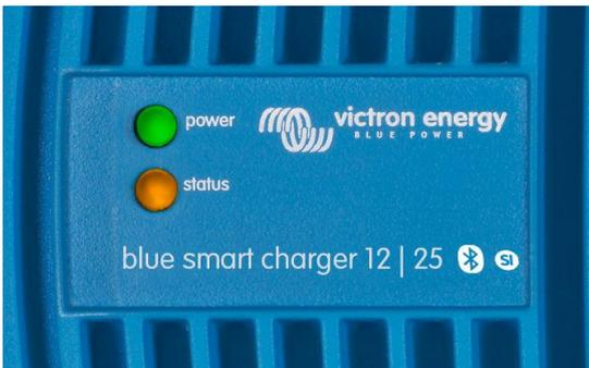
3. Выберите режим зарядки, соответствующий типу аккумулятора с помощью приложения VictronConnect (необходимую предустановку заряда и максимальный ток заряда (стандартный или низкий) из списка настроек - см. раздел 5.2 «Использование VictronConnect»).
